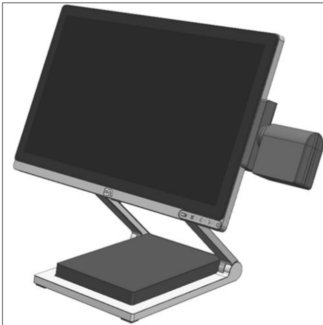
Illustration 15-28: Vue d'ensemble du système avec le BCR
