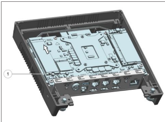
Illustration 12-11: Insertion d'un nouveau SSD
